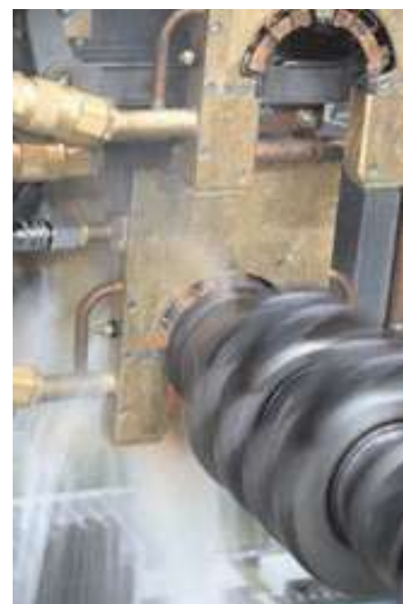
Bild 1: Induktor beim Aufheizen
