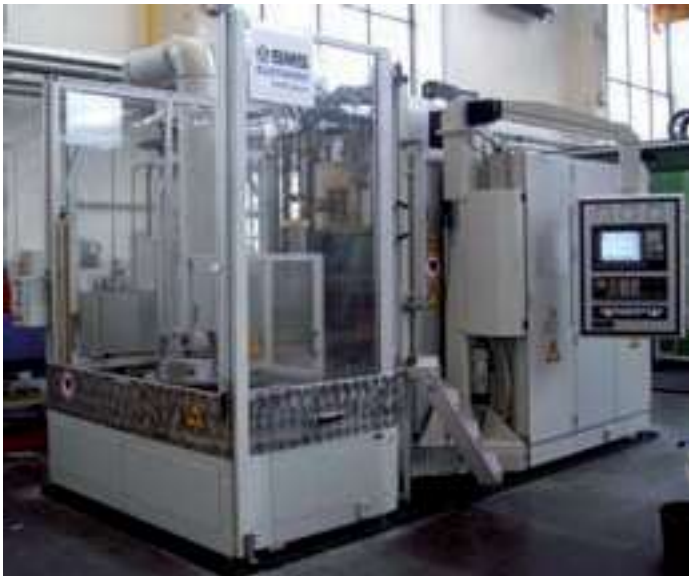
Bild 7: Induktionshärteanlage Typ UVH, Werkstück liegt horizontal Fig. 7: Induction Hardening Machine Type UVH, horizontally positioned ring
