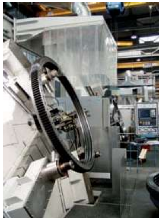
Bild 4: Induktionshärteanlage Typ RHM, Werkstück liegt schräg (70°)
