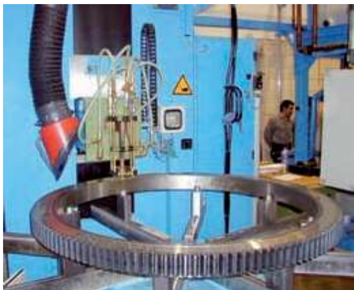
Bild 3: Induktionshärteanlage Typ ZHM, Werkstück liegt horizontal
