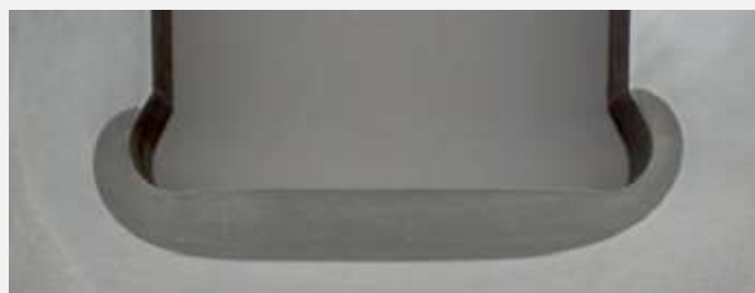
Bild 6b: Härtezone für beidseitigen Hinterschnitt
