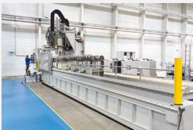
Bild 4: EloCrank™ XL für Großkurbelwellen (Quelle: SMS Elotherm)
