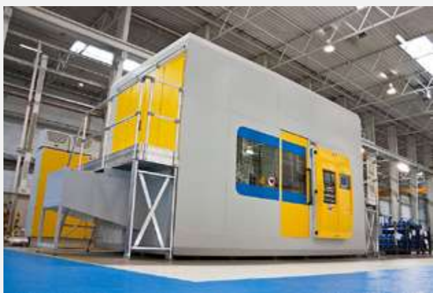
Bild 3: EloCrank™ für PKW-Kurbelwellen (Quelle: SMS Elotherm)
