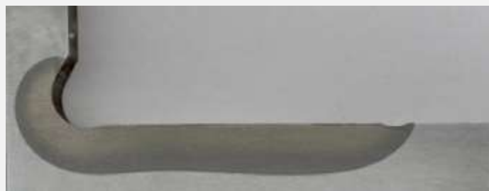
Bild 6a: Härtezone mit einseitigem Hinterschnitt
