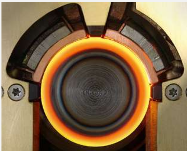
Bild 2: Halbschaleninduktor zum induktiven Randschichthärten von Kurbelwellen
