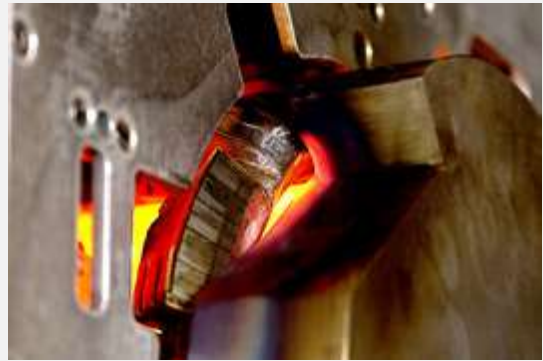
Bild 7b: Aufheizbild des Hinterschnittinduktors
