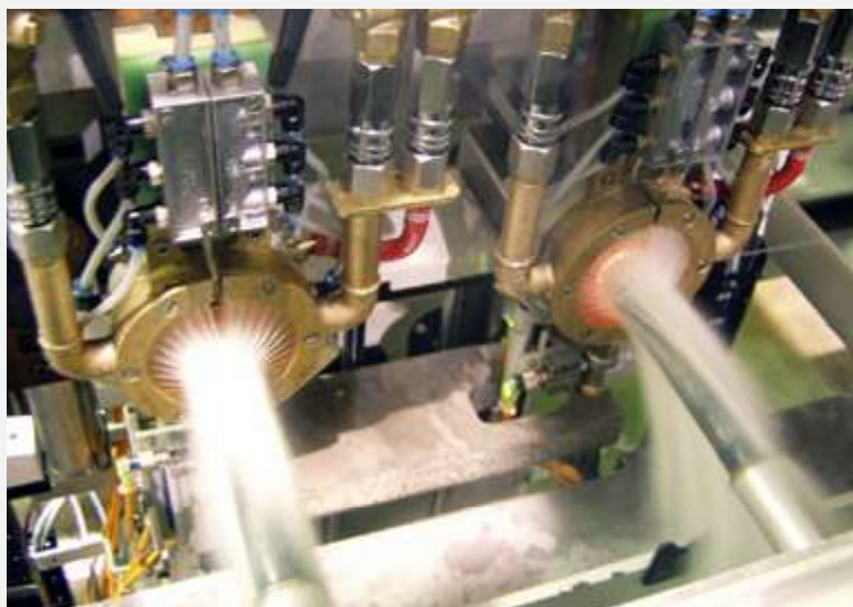
Bild 6: Induktor-Brause-Anordnung in horizontaler Doppelstation (Quelle: SMS Elotherm)
