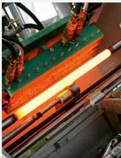
Bild 3: Vorschubhärtung einer Zahnstange in vertikaler Einspannung (Quelle: SMS Elotherm)
