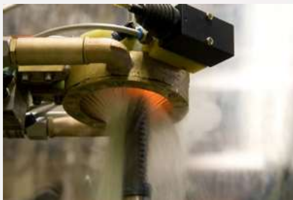
Bild 3: Vorschubhärtung einer Zahnstange in vertikaler Einspannung (Quelle: SMS Elotherm)
