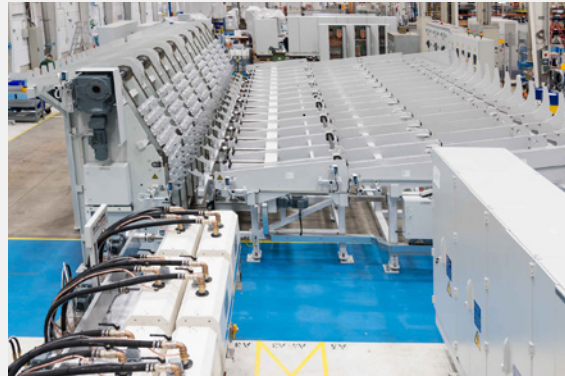
Bild 5: Stangenmagazin mit einer Kapazität von 30 t inkl. Warmablage
