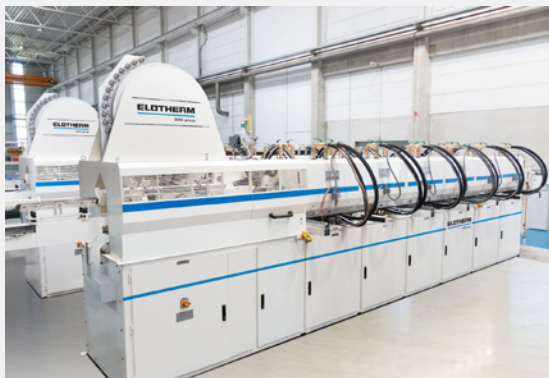
Bild 3: EloForge Induktionsanlage der neuesten Generation mit Leerfahreinrichtung, Zonentechnik iZone, Stand-by-Betrieb und vollautomatischem Induktorwechsel
