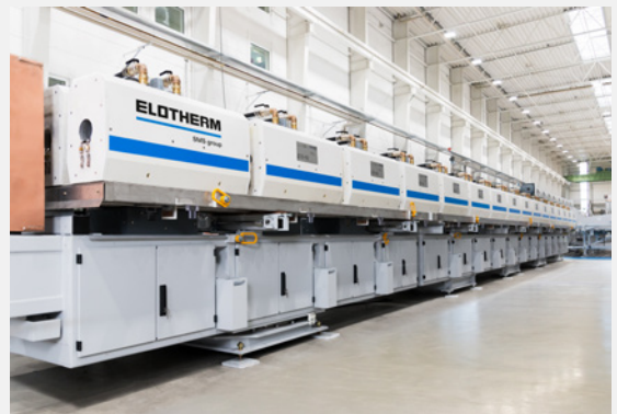
Bild 4: Induktive Stangenerwärmung für eine Hateburpresse des Typs HM75 mit einem Durchsatz von 20 t/h bei einem max. Stangendurchmesser von 90 mm
