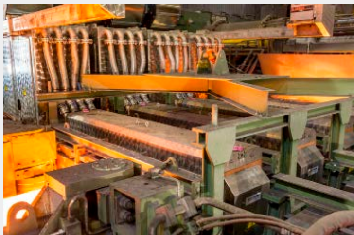
Bild 4: Integration einer Induktionserwärmung in eine CSP-Anlage
