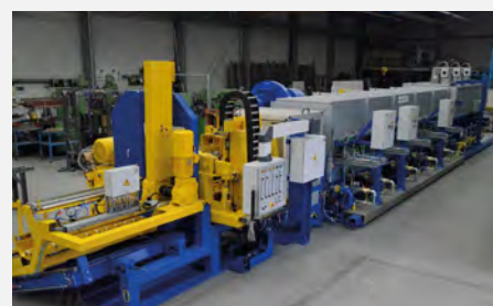
Bild 9: Kompletter Gas-Induktions-Inlineofen mit Warmsäge
