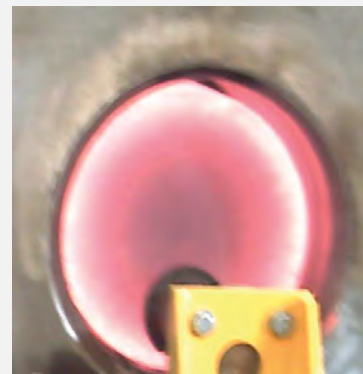
Bild 6: Sichtbare Eindringtiefen bei der induktiven Erwärmung von Bolzen
